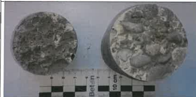
Abbildung 10 Bohrkern P2.2.a; Links: Ablösefläche des Spritzbetons Rechts: Ablösefläche des Altbetons
