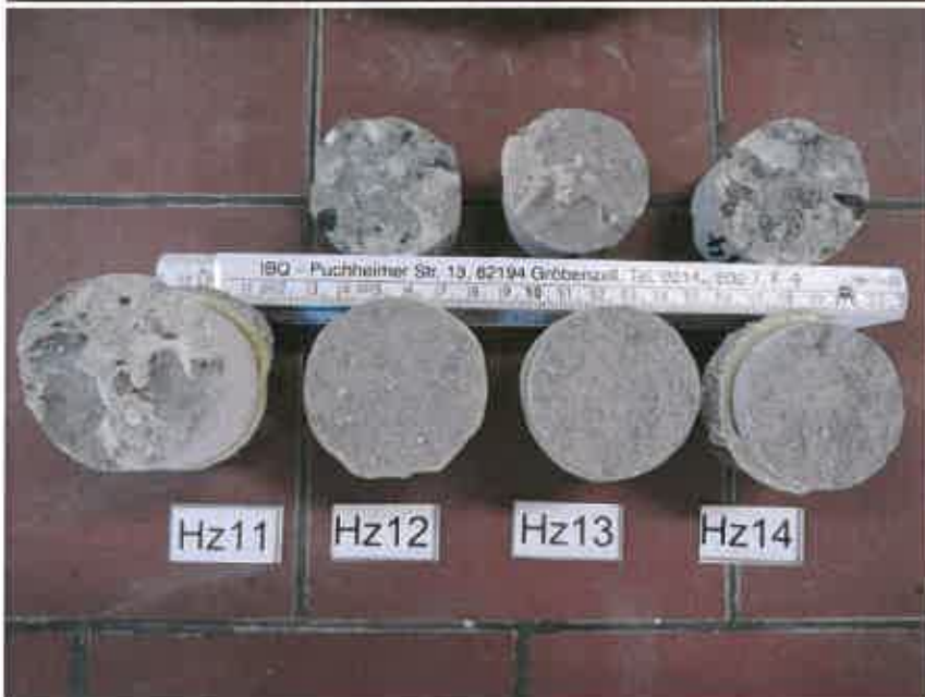
Bild 2 Haftzugstempel Hz11 - Hz14
