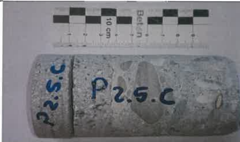
Abbildung 22 Bohrkern P2.5.c Mantelfläche
