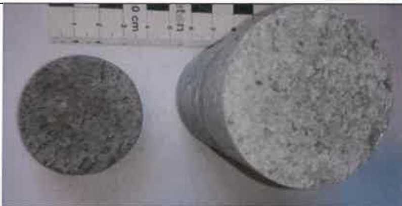
Abbildung 23 Bohrkern P2.5.c Links: Ablösefläche des Spritzbetons Rechts: Ablösefläche des Altbetons
