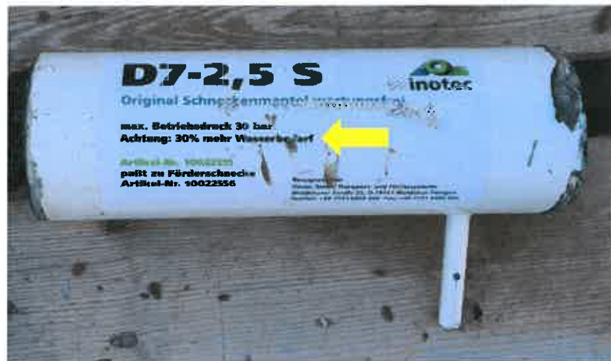
Foto 9: Eingebrennte Förderschnecke mit 30 % mehr Wasserbedarf
